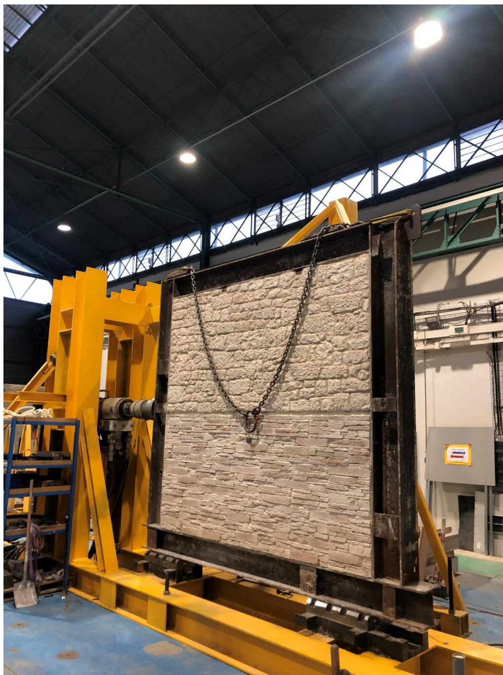
Photographie 17 : Vue du corps d'épreuve après essai
