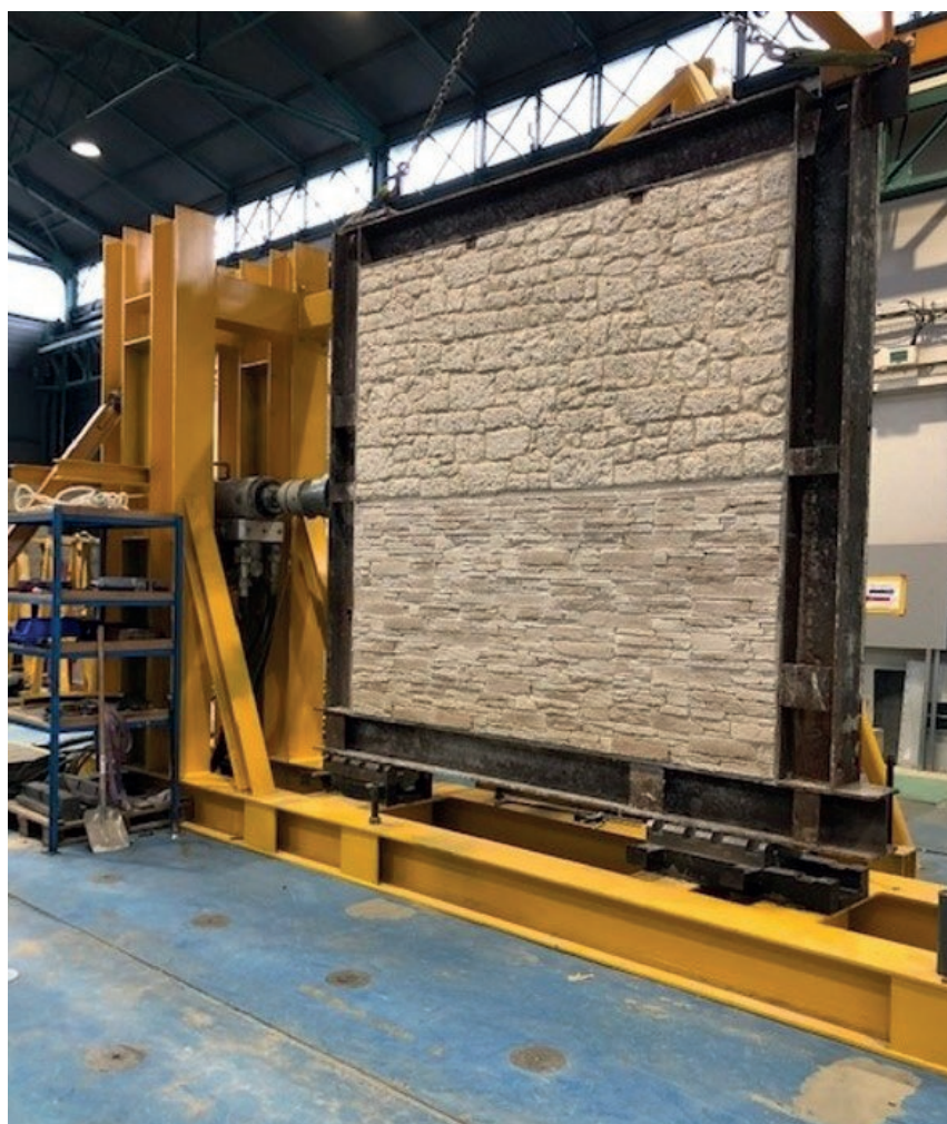
Panneau prêt à subir l'essai sismique au CSTB
